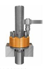
很长的全螺纹螺杆 一个有一大圈顶推螺钉的张紧 器,正确地通过顶推螺钉来拧紧 是必须的。
