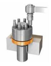
材料强度低 当连接件的材料强度较低时,需要 用一个厚的,更大的垫圈或附加 垫圈。
