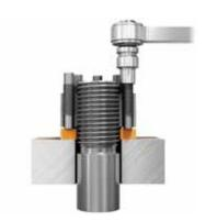
垫圈放置在螺纹的中心 确保垫圈不放置在底切的边缘或者配 合螺栓的半径范围。
